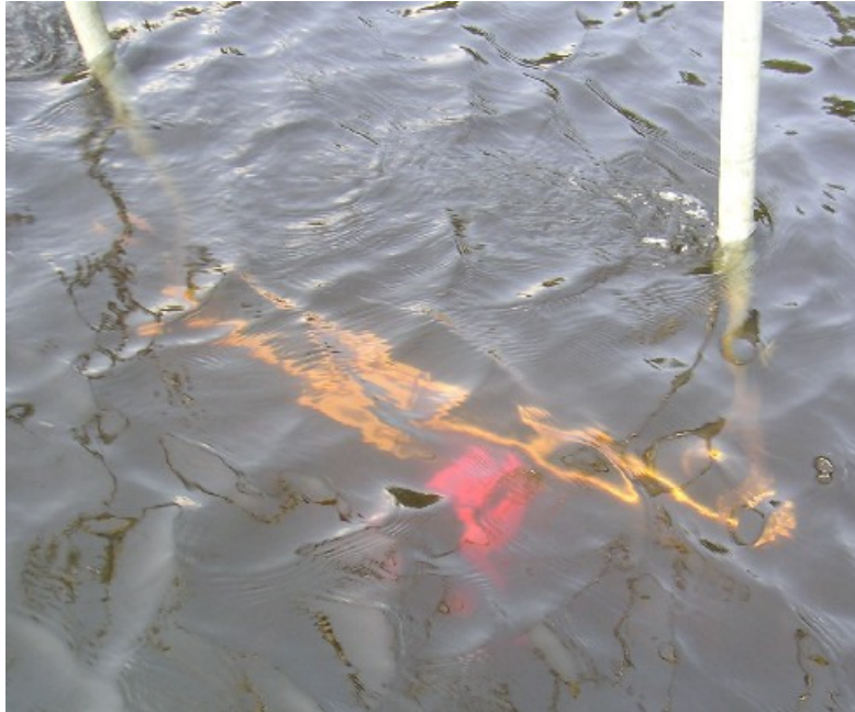
Figur 5. Ekolods svängare installerad i älven
